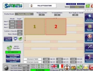
Software gestione "Smart-Setup" che permette, impostando dimensione scatola e pallet, la creazione in autonomia in pochi minuti dello schema/ricetta di pallettizzazione.
